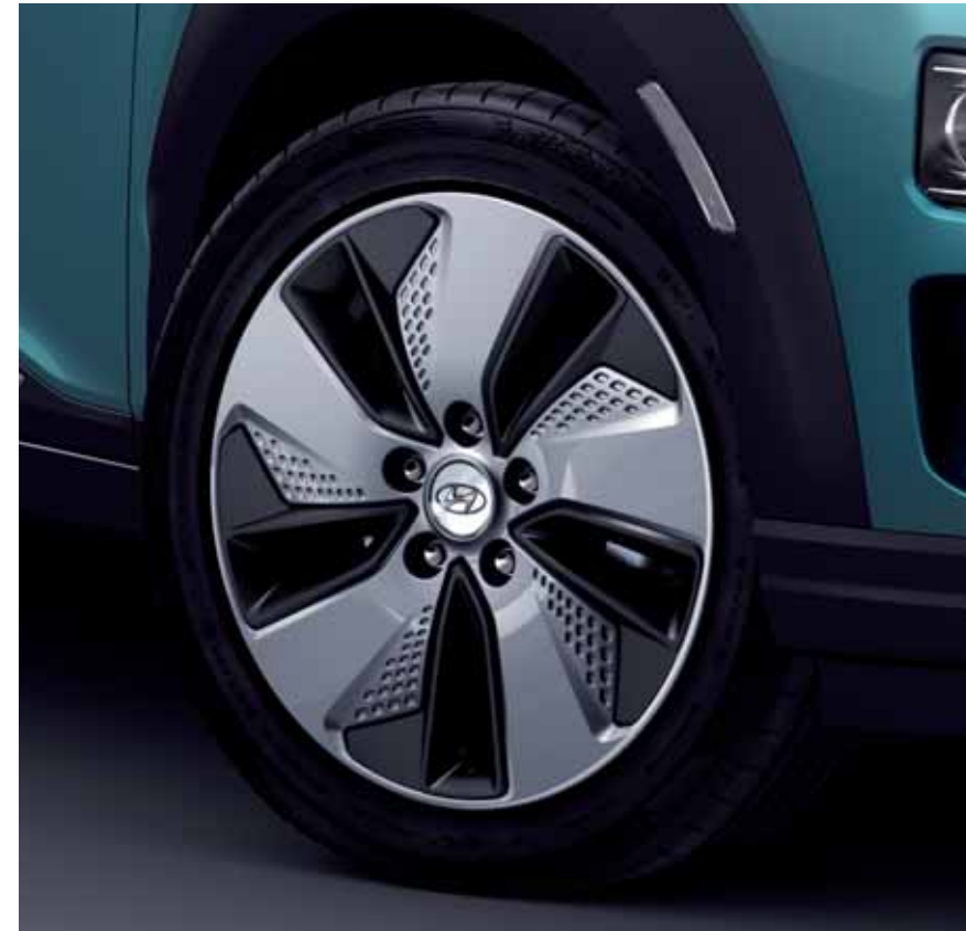
Aerodynamicky optimalizovaná 17" kola z lehké slitiny
